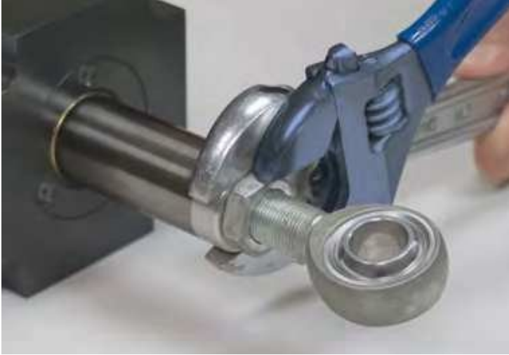
Hình 2.7: Giữ cố định trục đẩy sử dụng cờ-lê trên bề mặt phẳng trên đầu cuối của trục khi kết nối phụ kiện, nối trục hay nối tải với động cơ. Hai cờ-lê được sử dụng trong trường hợp này: một cái dùng để ngăn trục đẩy xoay, một cái để khóa chặt khớp nối cầu.
